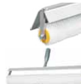
Kryt na odvzdušňovací váleček zabraňuje potřísnění stěn při odvzdušňování mokrého materiálu.
