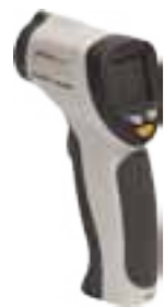
Zařízení na měření teploty
