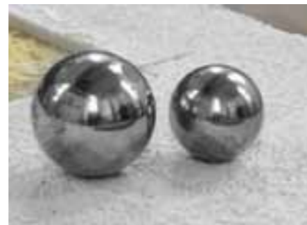
Ocelové koule pro zkoušky mechanické odolnosti
