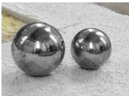
Ocelové koule pro zkoušky mechanické odolnosti
